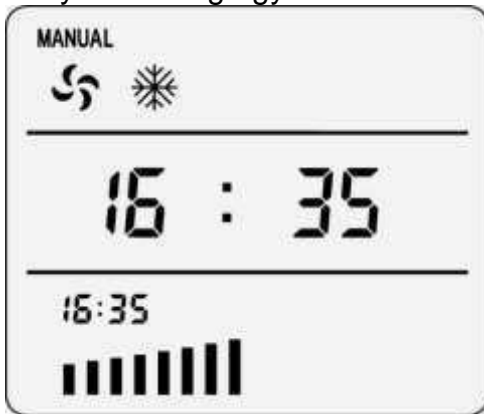
4/1 kép be van kapcsolva a ventilátor és a hűtés
