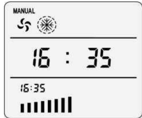
4/2 kép a pumpa nem működik (nincs víz)
